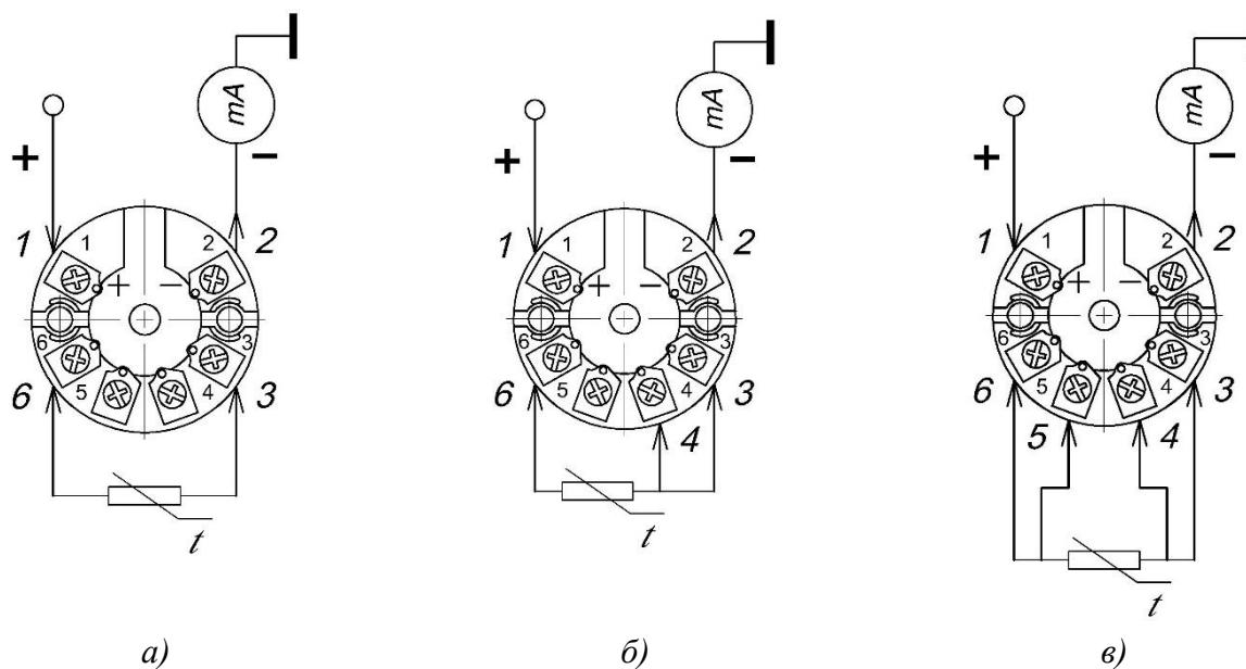
**Рис. 2 — Схемы подключения к клеммам измерительного преобразователя**
