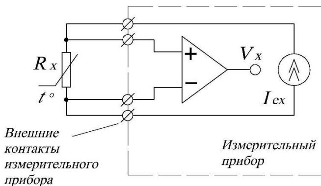
Рис. Е.3 — Четырехпроводная схема подключения термометра сопротивления
