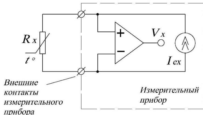
Рис. Е.1 — Двухпроводная схема подключения термометра сопротивления
