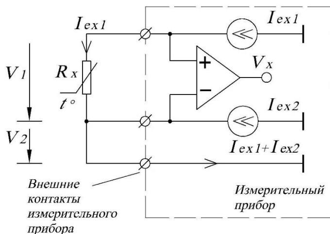
Рис. Е.2 — Трехпроводная схема подключения термометра сопротивления
