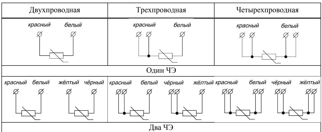
Рис. 1 Схемы соединений и маркировка внутренних проводов ДТ
