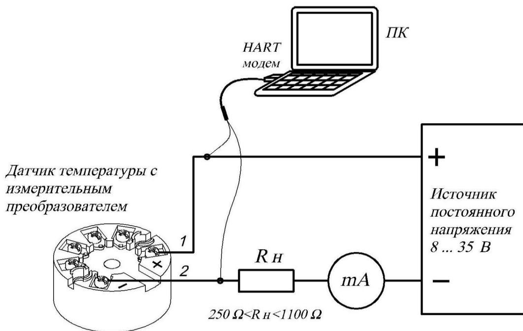
Рис. E.4 — Схема подключения датчиков температуры
