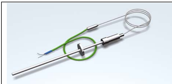
Рис. № 6. Термопреобразователь КТХА (КТНН) 02.15 для периодических кратковременных измерений температуры расплавленного электролита в ваннах электролизеров при производстве первичного алюминия. Патент на полезную модель № 66040.
